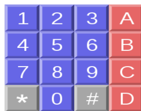
Fig. 3 DTMF Keypad Layout
